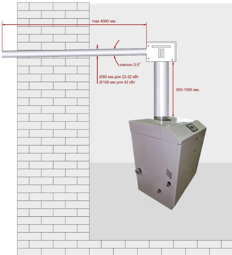
При монтаже газохода следует обеспечить необходимый по “СНиП 41-01” уровень огнестойкости. Для корректной работы котла в комплекте с турбонасадкой, необходимо обеспечить постоянное поступление в помещение свежего воздуха.
